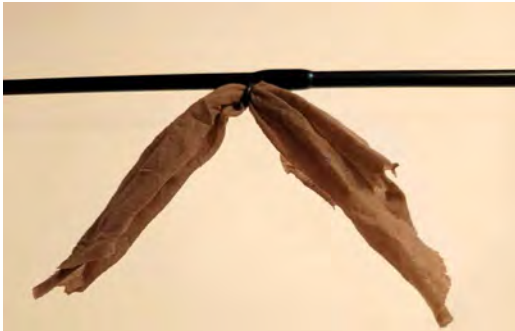
Ringeinlagen mit Strumpfstoff auf Beschädigungen prüfen
